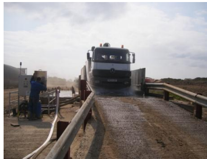
Mit der Verlängerung des manuellen Reinigungsschlauches kann der Laderaum nach der Wäsche gereinigt werden, ohne die effektive Auslastung der Anlage zu behindern.
