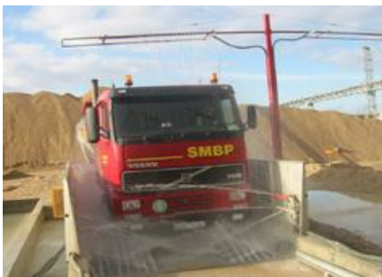
4 Pumpen mit einer Totalleistung von 6400 Lt/Min.
