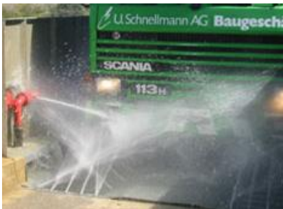
Oszillierende Seitendüsen zur Wäsche der Kotflügel
