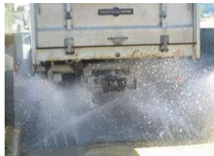
Intensive Reinigung der Profile durch die Bodendüsen
